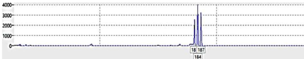
**Рис. 2.** Электрофореграмма ПЦР-продуктов микросателлитного локуса Sb04, меченого красителем ROX, у гибрида сахарной свеклы Смена селекции ЛОСС
