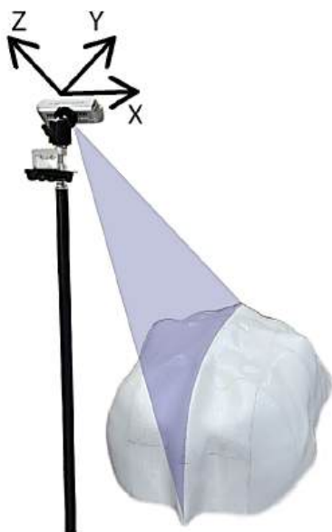
Рис. 2. Схематичное представление съемки макета коровы
