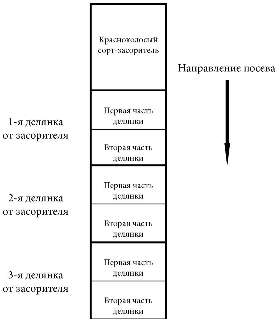
Рис. 1. Схема опыта по изучению величины механического засорения сеялкой СН-10Ц
