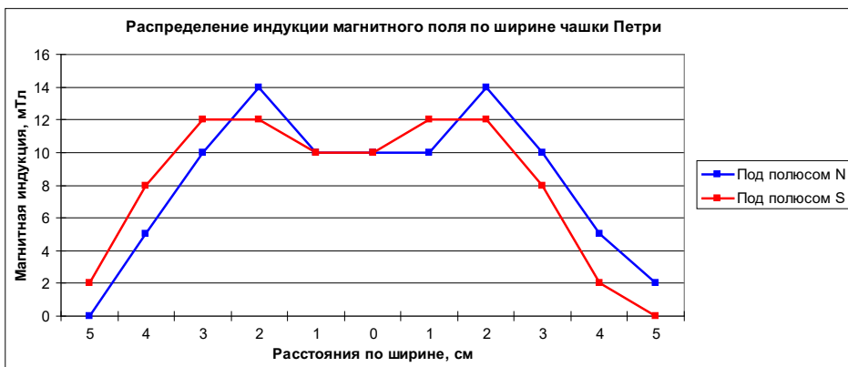
Рис. 1. Распределение магнитного поля в чашке Петри на уровне расположения семян
