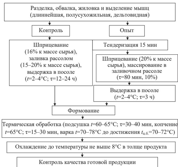
**Рис. 7.** Технологическая схема производства цельномышечной конской ветчины «Здоровье»
