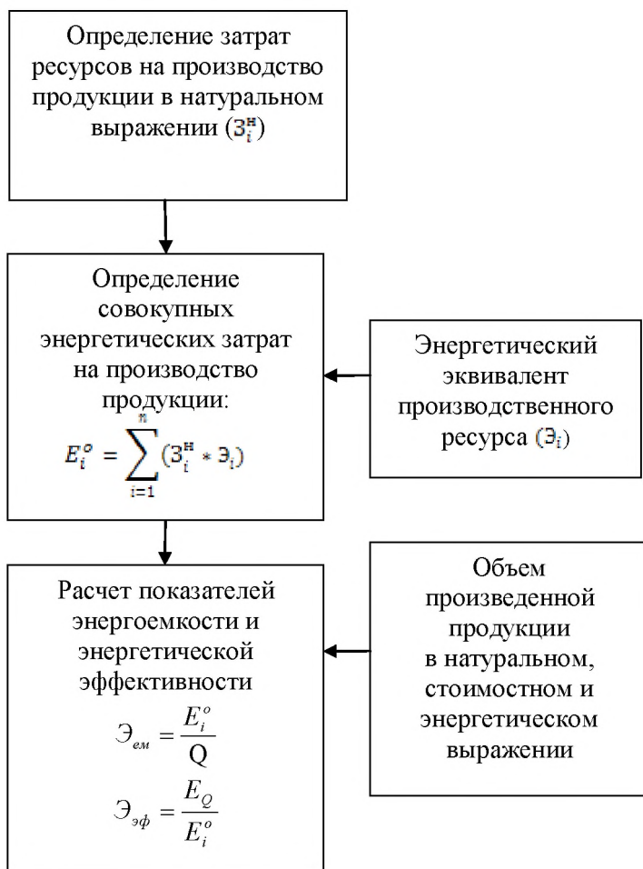
Рис. 1. Методика энергоэкономической оценки с использованием эквивалентов энергетических затрат производственных ресурсов: E_i^o — полные энергетические затраты на производство продукции, МДж; Z_i^n — затраты на производство i -го вида в натуральном выражении; \mathcal{E}_i — энергетический эквивалент, характеризующий расход энергии на производство ресурса, МДж/ед.; i — порядковый номер статьи затрат; Q — объем производства в натуральном или стоимостном выражении; E_Q — объем производства в энергетическом выражении, МДж
