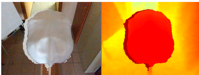
Рис. 11. Данные с камеры RealSense D435 Figure 11. Data from the RealSense D435 camera
