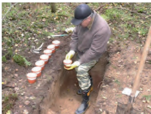
Рис. 2. Фация ельника-черничника зеленомошного в кв. 95 ЦЛГПБЗ: а — проф. И.И. Васенев (у нивелира) проводит привязку стационара в кв. 95 (29.09. 2011 г.); б — проф. И.М. Яшин устанавливает сорбционные лизиметры (СП) в профиль подзола (30.09.2011 г.)
