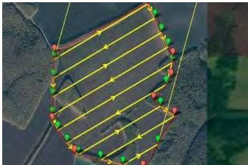
Рис. 1. Схема облёта посевной площади по точкам
