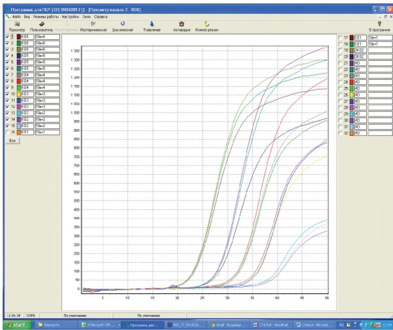
**Рис. 2.** Кинетические кривые серии 10-кратных разведений ДНК ГМ-линий сои MON89788, полученные на приборе для ПЦР-РВ АНК-32 (ИАП РАН, Санкт-Петербург)
