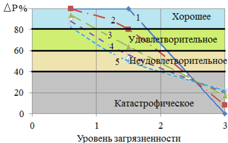
Рис.8.11. Изменение степени сохранности фоновое качество воды и экологического состояния рек в зависимости от уровня загрязненности и коэффициента вариации стока C_v (при C_s=2C_v ). (1- C_v=0.1 , 2- C_v=0.3 , 3- C_v=0.5 , 4- C_v=0.7 , 5- C_v=0.9 )
