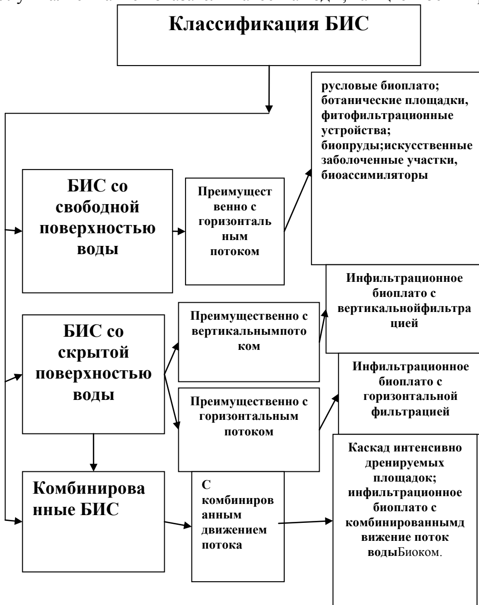
Рис.10.4. Классификация БИС по конструктивных особенностям
