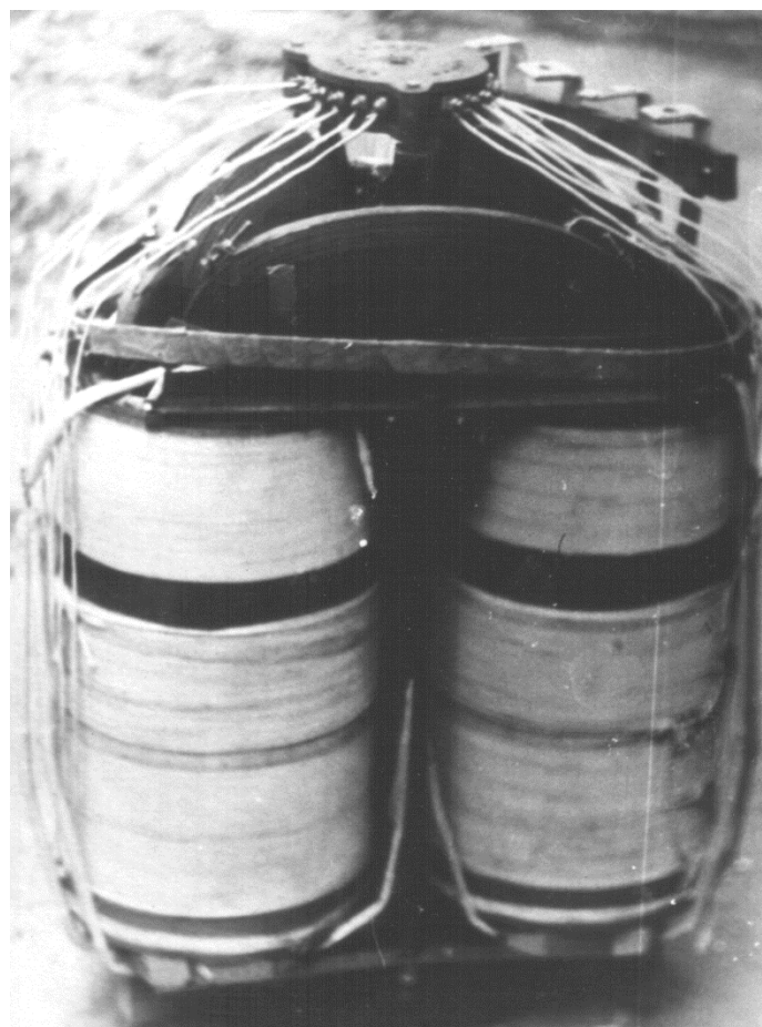
Рис. 5.18 – Активная часть опытно-промышленного образца трансреактора УРТ-250/10 (фото)
