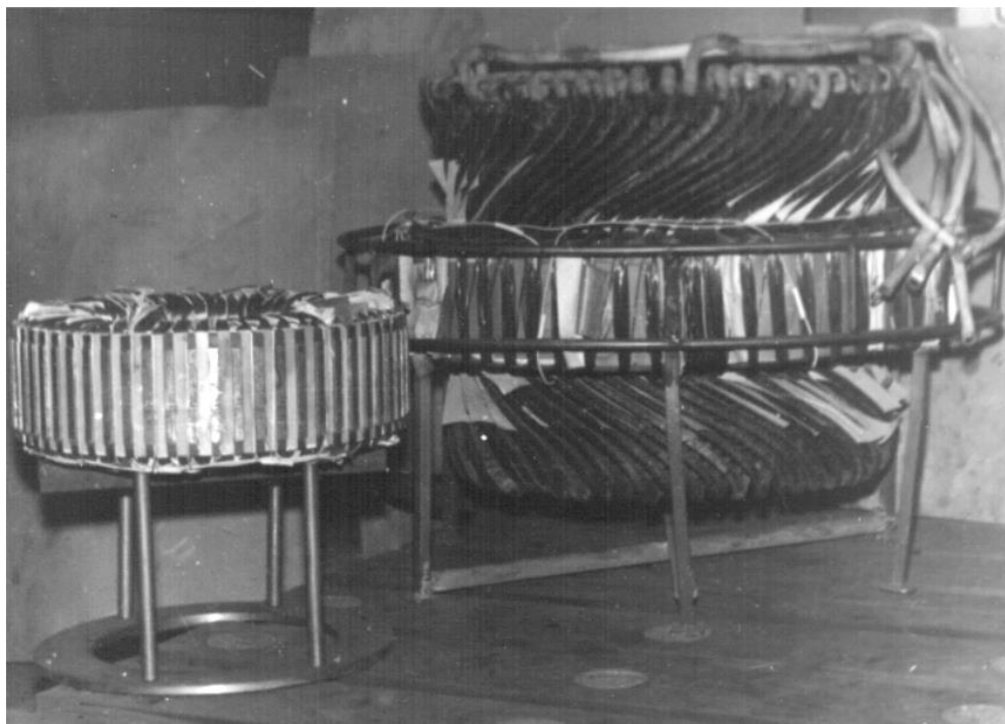
Рис. 5.6 – Управляемый реактор с вращающимся магнитным полем (УРВ5) намагничивание магнитопровода – симметричное; изготовлен на основе пластин статора асинхронного двигателя ВАО14-4 (наружный диаметр пластин – 0,85 м)
