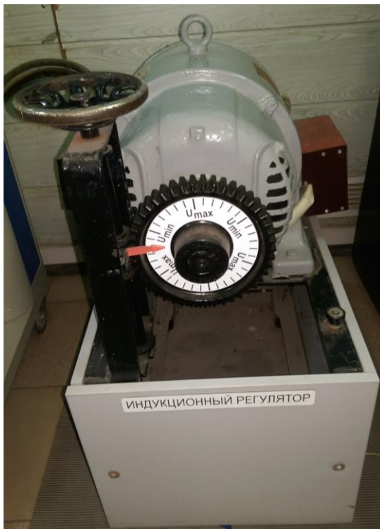
Рисунок 14.7. – Фотографии приборной панели лабораторного стенда – (а) и трехфазной асинхронной машины с неподвижным ротором – (б): p = 3
