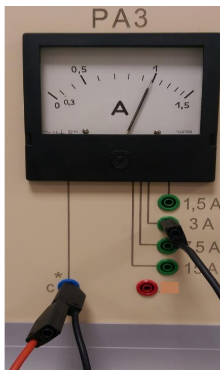
Рисунок 10.28. – К иллюстрации перехода с диапазона измерений токов «15 А» на диапазон измерений токов «3 А» (на примере амперметра PA3 в фазе W обмотки статора)
