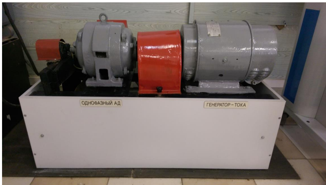
Рисунок 12.9. – Фотография исследуемого агрегата «Однофазный асинхронный двигатель – генератор постоянного тока» (номинальные данные – см. рис. 12.7)
