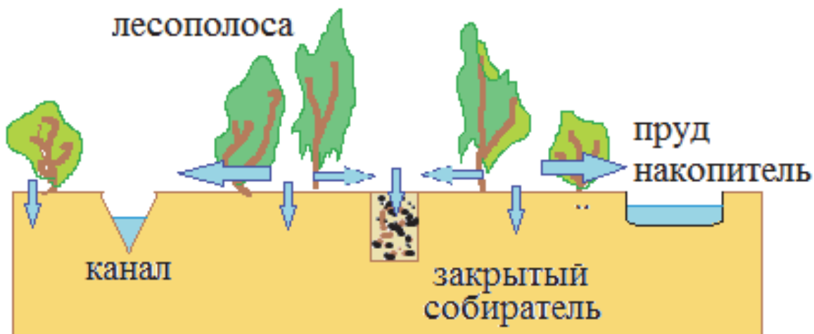
Рис. 7.5. Схема управления стоком при атмосферном типе загрязнения
