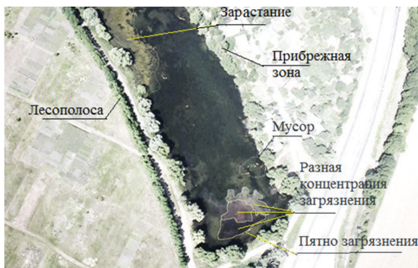
Рис. 7.1. Снимок пруда с БПЛА. Хорошо видно состояние прибрежной зоны, участок интенсивного зарастания водоема, пятно загрязнения и замусоренный участок [ http://www.solomax.org.ua/ecolog_ru.html ]
