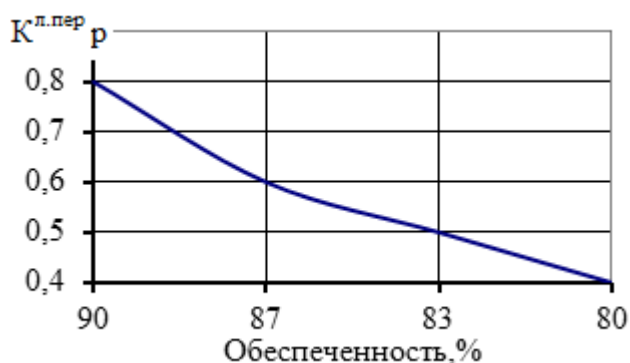
Рис. 5.6. Зависимость модульного коэффициента левой точки перегиба ( K^{л.пер}p ) кривой распределения объемов стока от обеспеченности годового стока
