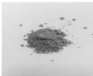
Рисунок 2 - Исходный вид порошка после химического диспергирования А1-V (а) и после термической термообработки при 1250 °C с выдержкой 1 час (б)
