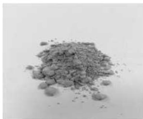
Рисунок 2 - Исходный вид порошка после химического диспергирования А1-V (а) и после термической термообработки при 1250 °C с выдержкой 1 час (б)
