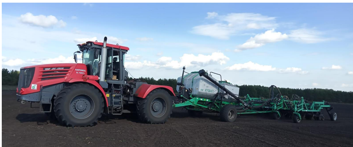
Рисунок 1 – Тягово-энергетическая оценка колесного трактора К-735 с посевным комплексом ПК 6.1 на посеве
