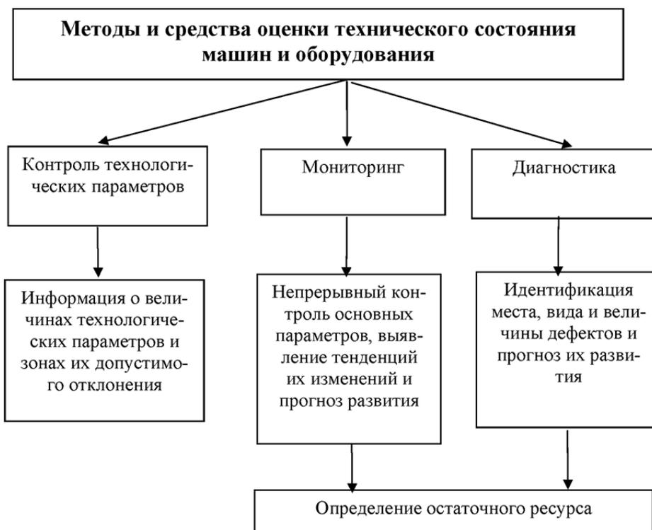
**Рисунок 1 – Структурная схема оценки технического состояния машин и оборудования**
