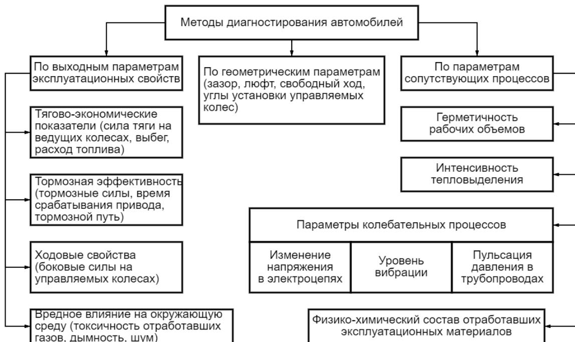
**Рисунок 3 – Методы диагностирования автомобилей**
