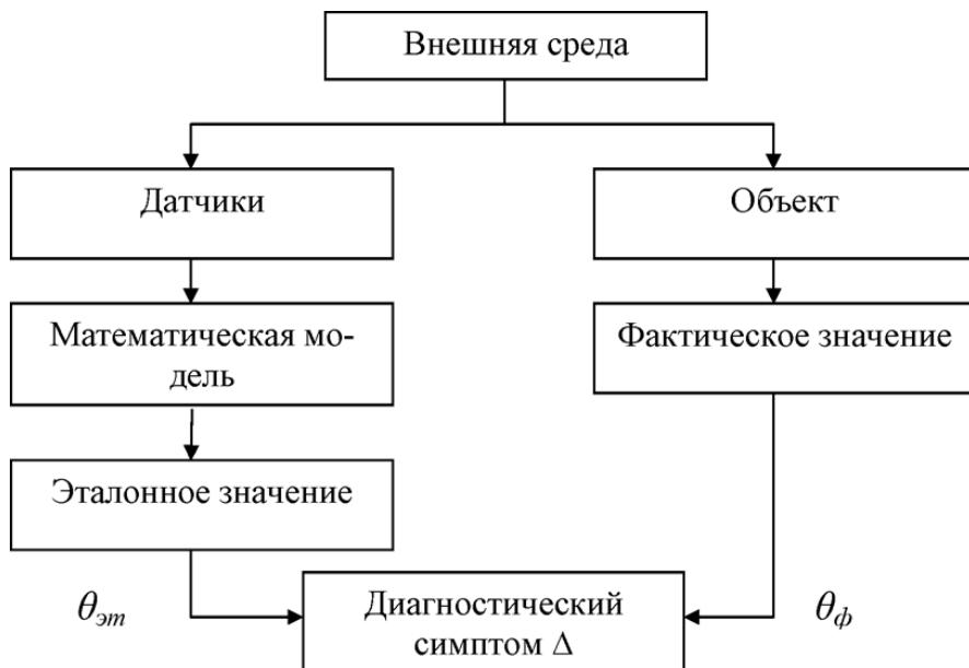
**Рисунок 2 – Структурная схема технической диагностики**
