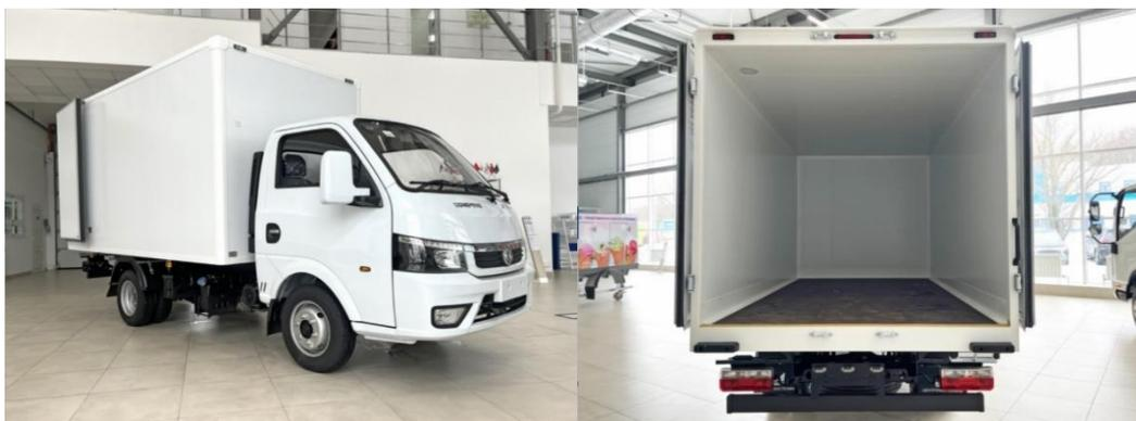
**Рисунок 2 – Изотермический фургон**
