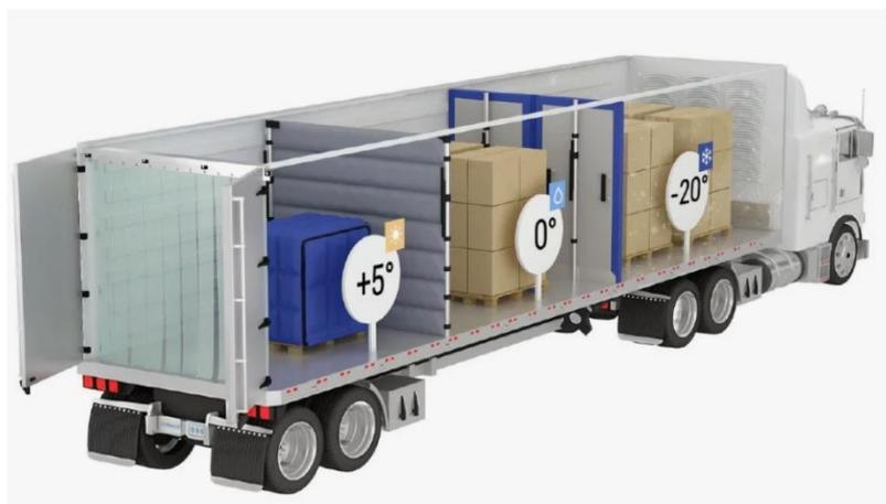
**Рисунок 1 – Перевозка молочной продукции с разным температурным режимом**
