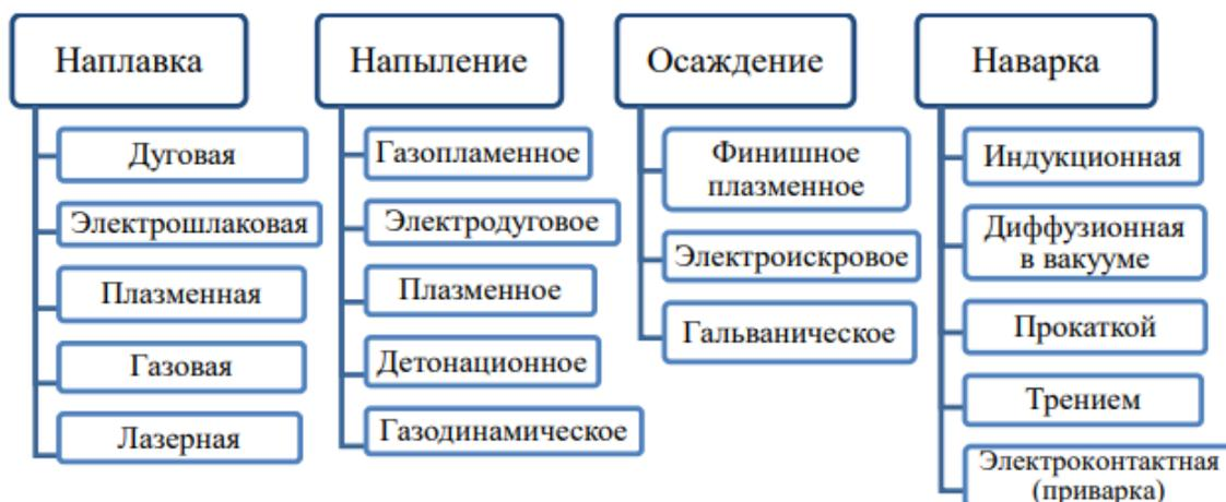
**Рисунок 1 - Методы упрочнения рабочих органов**
