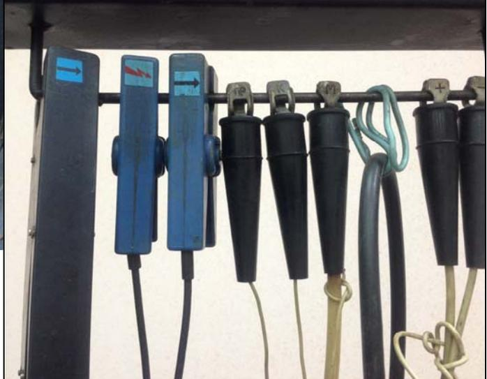
**Рис. 1.3. Жгуты для подключения к автомобилю**
