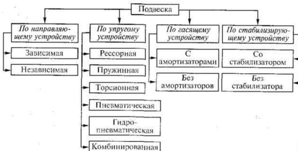
Рис. 2 - Типы подвесок, классифицированных по различным признакам
