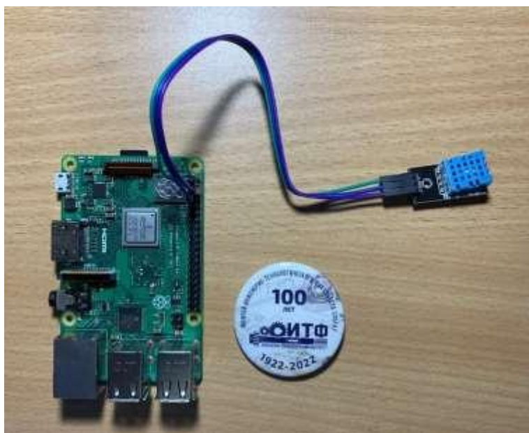
Рис. 2 – Общий вид микрокомпьютера Raspberry Pi с тестовыми датчиками температуры и влажности
