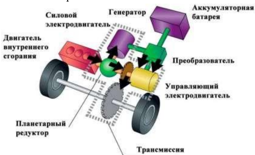
Рис. 2 – Общая схема комбинированной гибридной силовой установки
