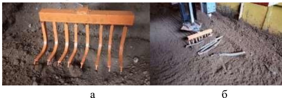
Рис. 2 -Экспериментальные исследования с разработанной моделью кустореза: а – установка модели в рабочее положение; б – процесс корчевания.
