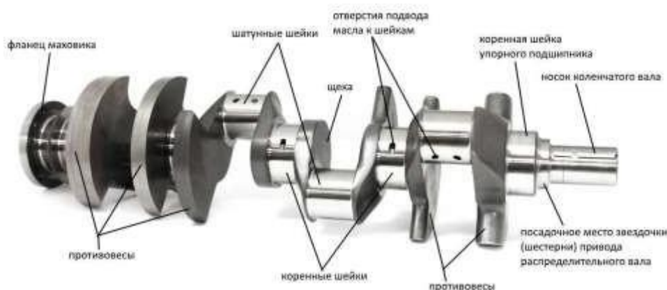
Рис. 1 – Составные части коленчатого вала.
