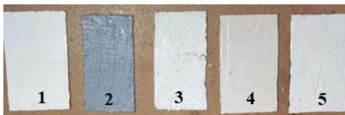
Рис. 1 – Внешний вид образцов после нанесения покрытий с различными наполнителями: 1 – эталонный образец без наполнителя; 2 – с углеродными нанотрубками; 3 – с окисью кремния; 4 – с графитом; 5 – с мелом.
