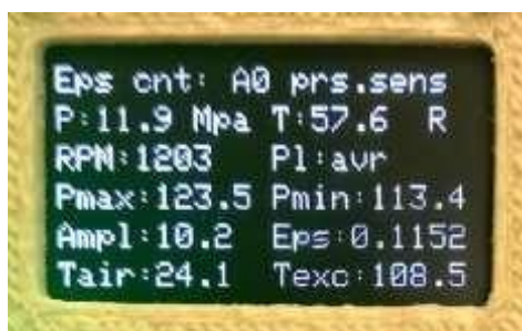
Рис. 1 – ИДС при контроле насоса по коэффициенту пульсации давления
