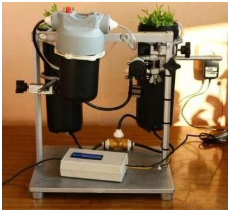
Рис. 2 – Функционирующий прибор для сбора корневых выделений растений
