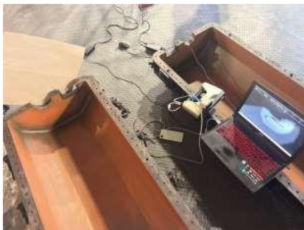
Рис. 3 – Реверс-инжиниринг. 3D-сканер в процессе оцифровки образца.
