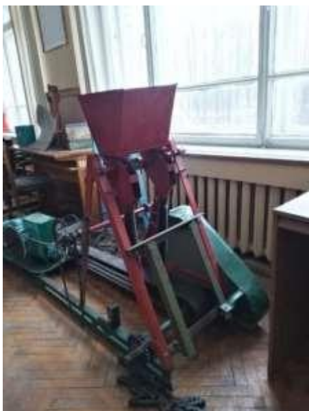
Рис. 3 - Подготовка лабораторной установки для определения качества работы высевяющих аппаратов: 1 - бункер, 2 – высевяющие аппараты, 3 - семяпровод, 4 - рама, 5 - транспортерная лента, 6 и 7 - электродвигатель, 8 - редуктор, 9 – привод высевяющих аппаратов
