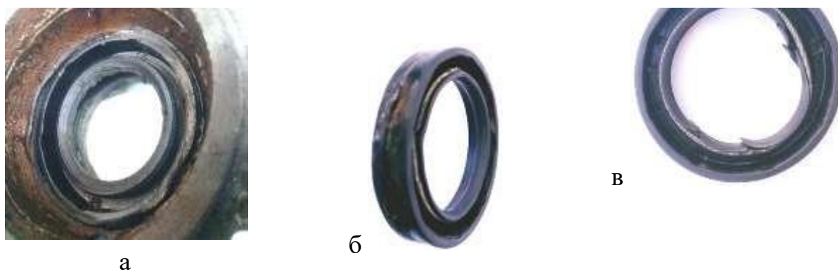
Рис. 2 – Основные дефекты манжет:
