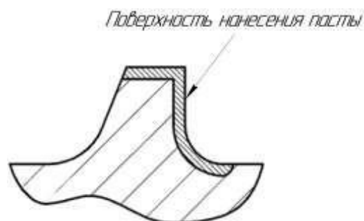
Рис. 1 – Поверхность шнека подвергающаяся диффузионному борированию
