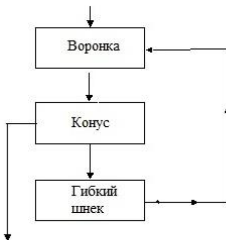
Рисунок 1 – Схема движения материального потока в первом смесителе
