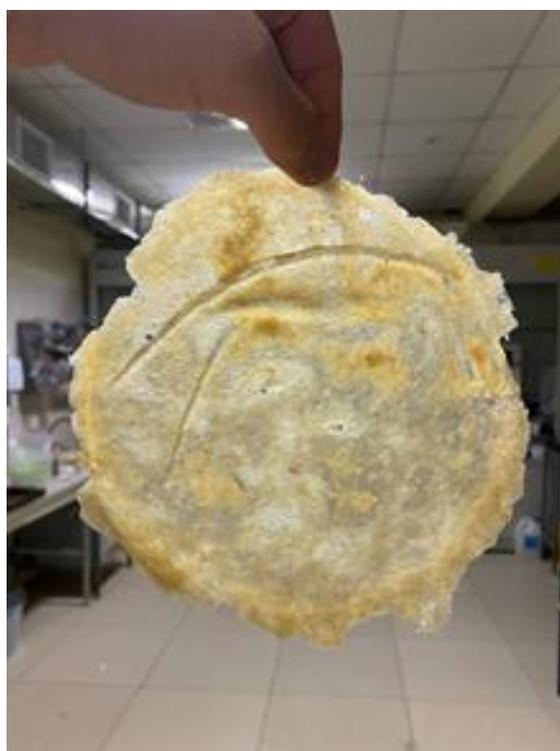
Рисунок 2 – Внешний вид коллагеновой пленки, полученной с применением ферментного гидролиза со смесью ферментов алкалазы и нейтразы
