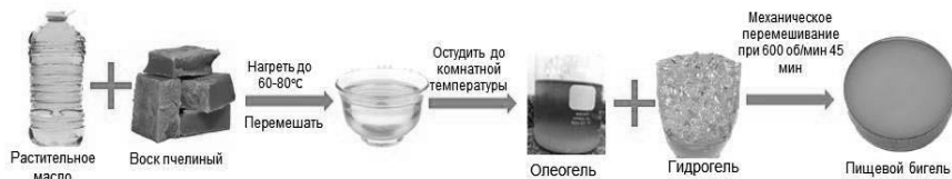
Рисунок 1 – Схема получения пищевого бигеля
