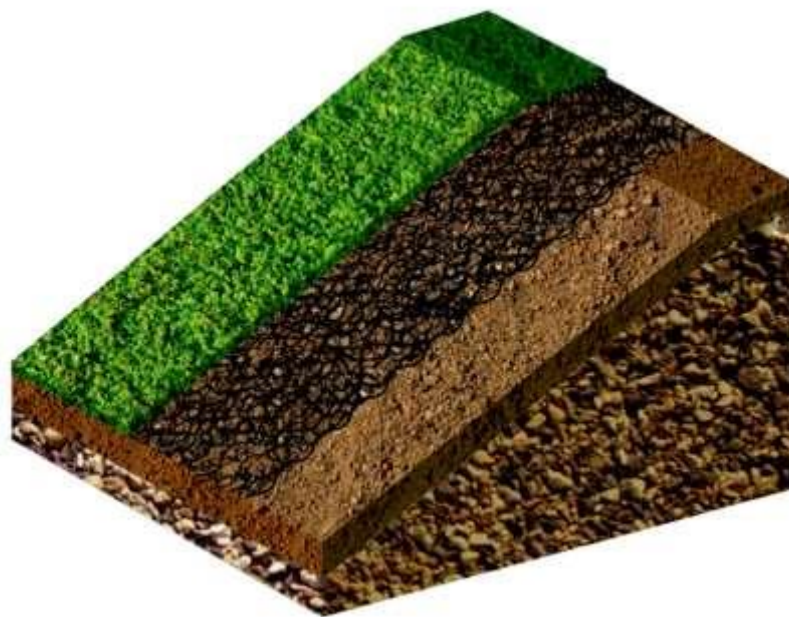
Рис. 1 Укладка противоэрозионного материала - геомата на откос
