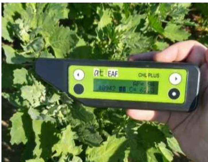
Рисунок 1. Измерение содержания хлорофилла в листьях квиноа с помощью прибора atLEAF CHL PLUS, Полевая опытная станция РГАУ-МСХА, 2022 г.
