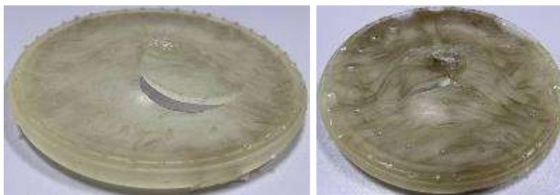
**Рисунок 3 – Виды разрывов диафрагм после испытаний**
