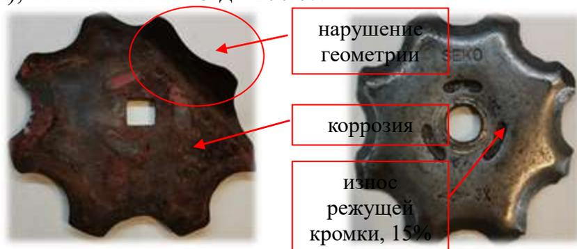
**Рис. 1 Износ ножей типа «Звездочка» в период эксплуатации 3 месяца**
