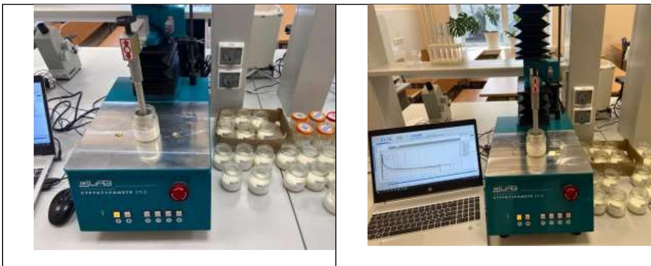
**Рис. Измерение структурно-механических показателей сметанных продуктов**
