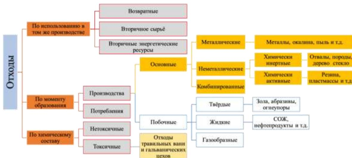
**Рис. 1 Классификация отходов по их признакам образования и возможности повторного использования**
