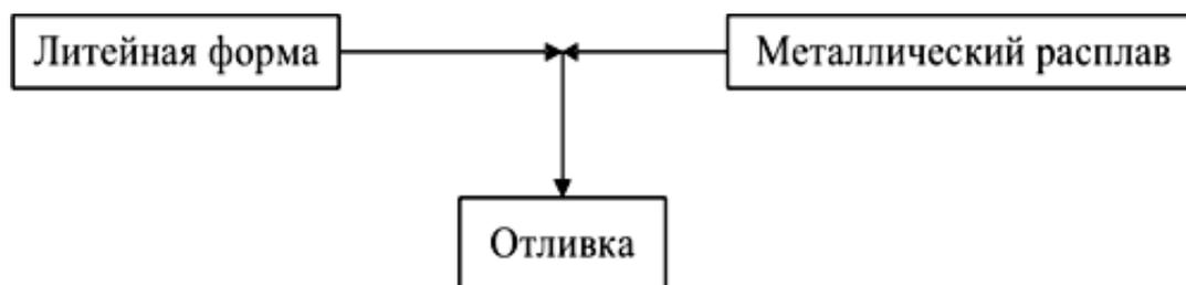
Рис. 3.1. Схема получения отливок.
