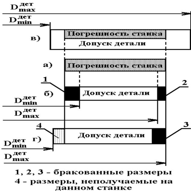
Поэтому на стадии технологической подготовки производства и в процессе производства осуществляется оценка точности технологической операции. Сущность этой оценки в следующем. Устанавливаются предельные размеры, которые выдает система СПИЗ (станок-приспособление-инструмент-заготовка) при обработке конкретного размера детали в зависимости от технического состояния станка и приспособления. Определение предельных размеров системы СПИЗ осуществляется по специальной методике.
