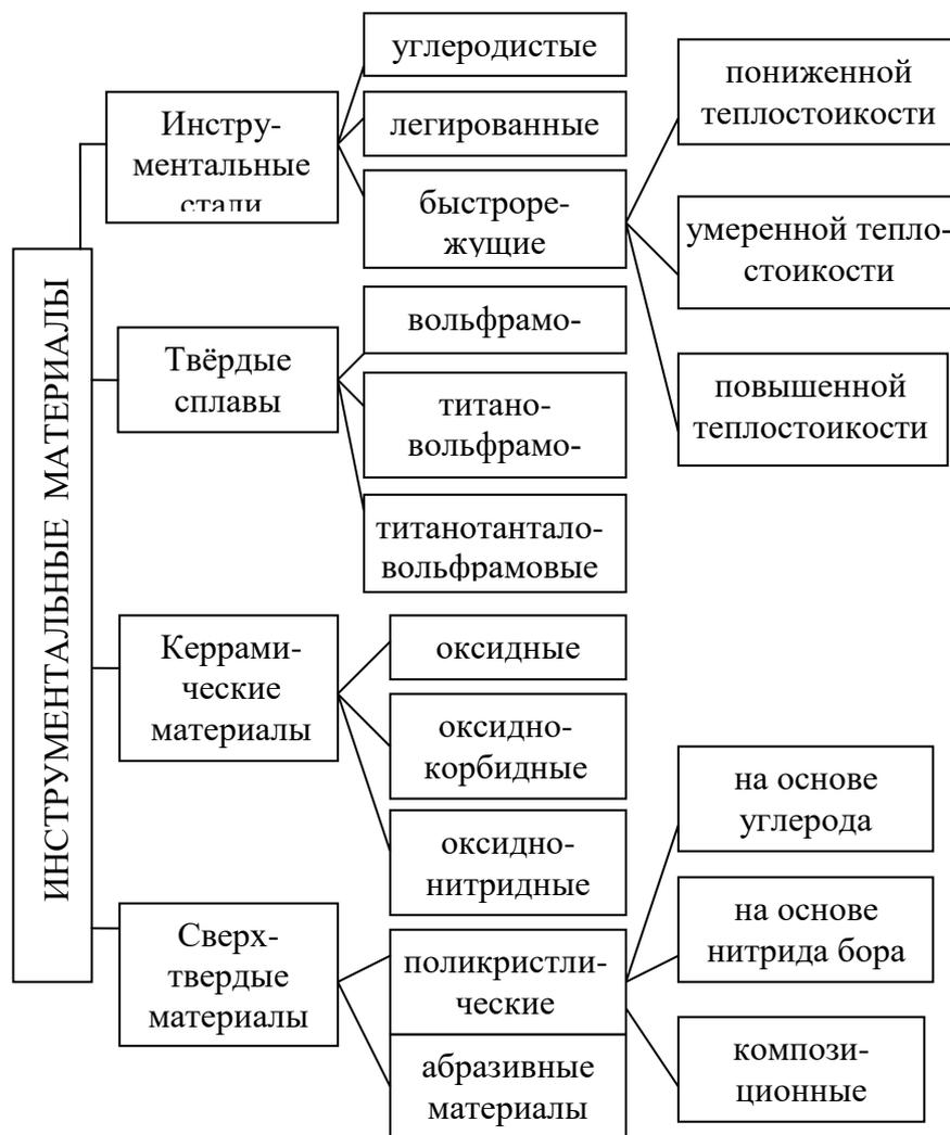
Рис. 9.2 Классификация инструментальных материалов
