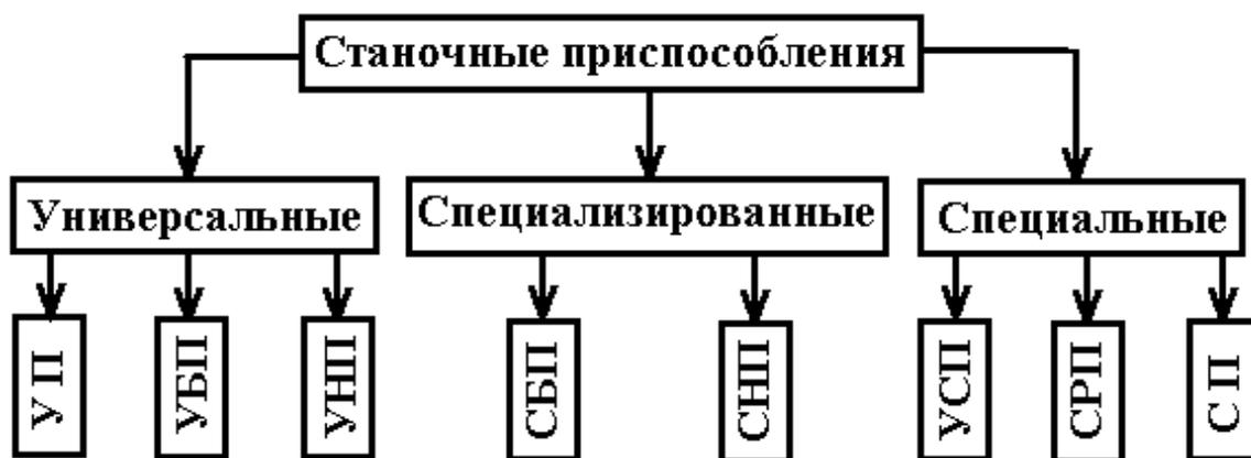
Рис. 8.1 Специализация станочных приспособлений
