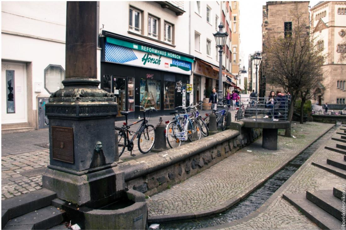
Рис. Б.2 - Бонн, отвод открытым лотком с перепуском из дождеприемной решетки.
