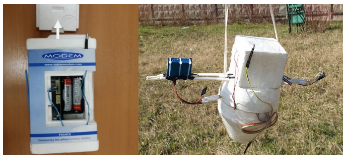
Рис. 1. Внешний вид радиозондов с оптическими датчиками (слева Modem, Франция, справа MP3-3, Россия). Белые стрелки показывают направление максимума диаграммы направленности датчиков
