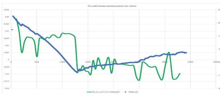
Рис. 3. График производной среднего уровня сигнала (зеленая линия) и температуры (синяя линия).
