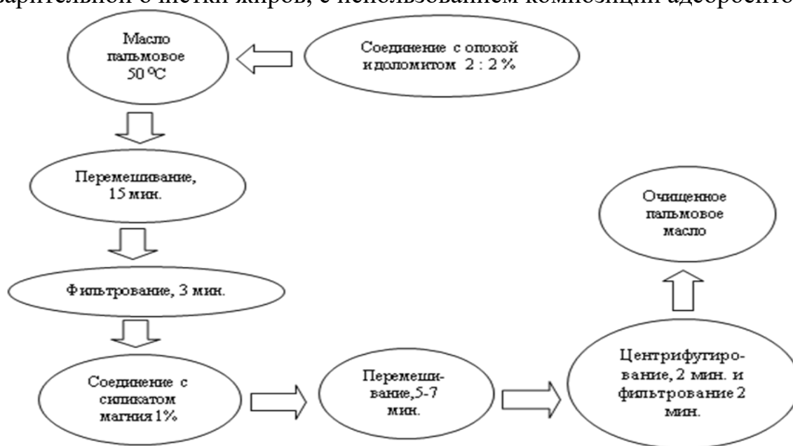
Технологическая схема очистки пальмового масла
