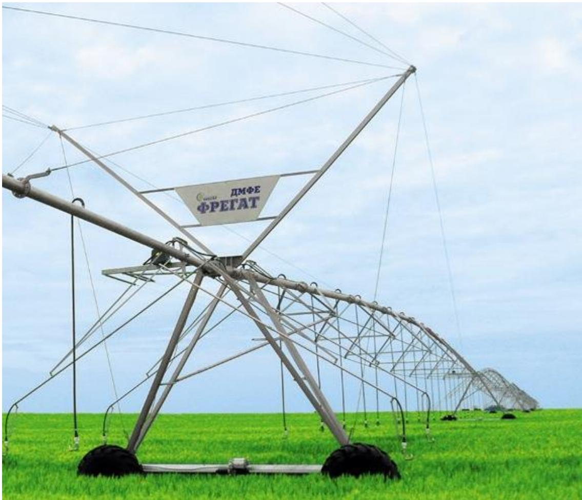
Рисунок 1.16 – Ферменная система ДМФ-К «Фрегат»
