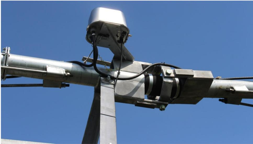
Рисунок 5.21– Приборы синхронизации движения в линию промежуточных тележек
