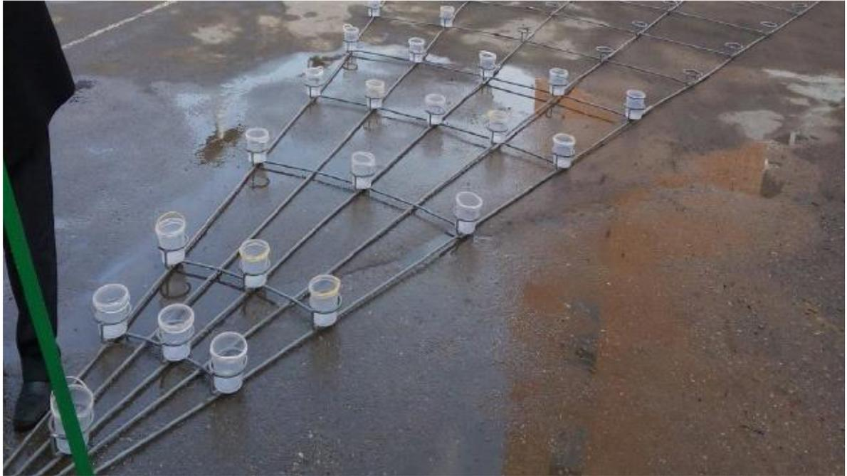
Рисунок. 5.15 – Расстановка дождемеров при лабораторных исследованиях
