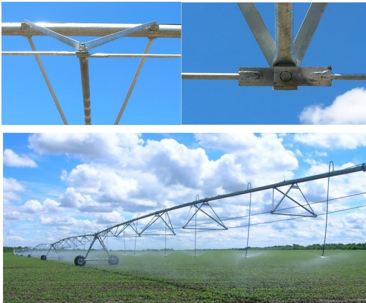
Рисунок 3.39 – Ферменная конструкция ДМ «КАСКАД» с длиной пролета 59,5 м
