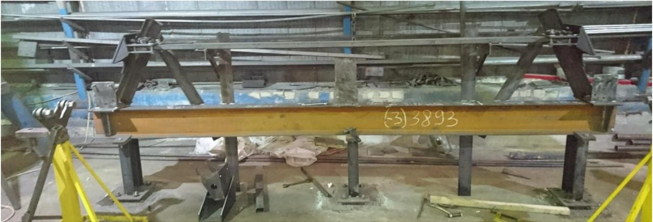
Рисунок 5.7 – Экспериментальная установка для изготовления и подбора конструктивных размеров ходовой тележки
