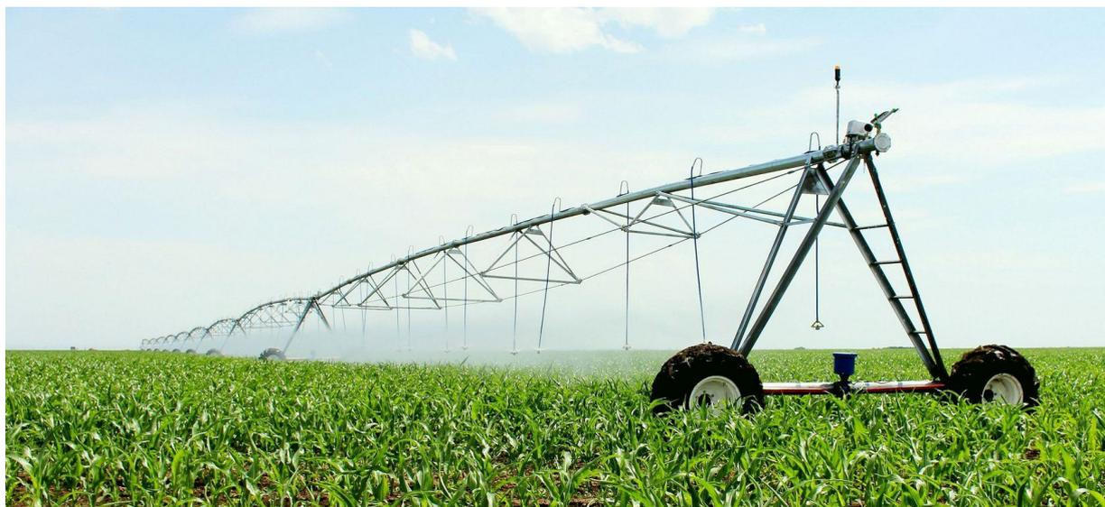
Рисунок 3.8 – «Кубань-ЛК1М» (КАСКАД) в работе
