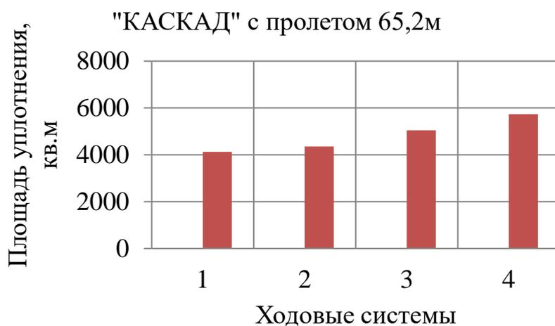
Рисунок 3.43 – Площадь уплотнения в зависимости от длины пролета для ходовых систем с шинами: 1 –14,9-24; 2 –15,5-38; 3 –16,9-24; 4 –18,4-26
