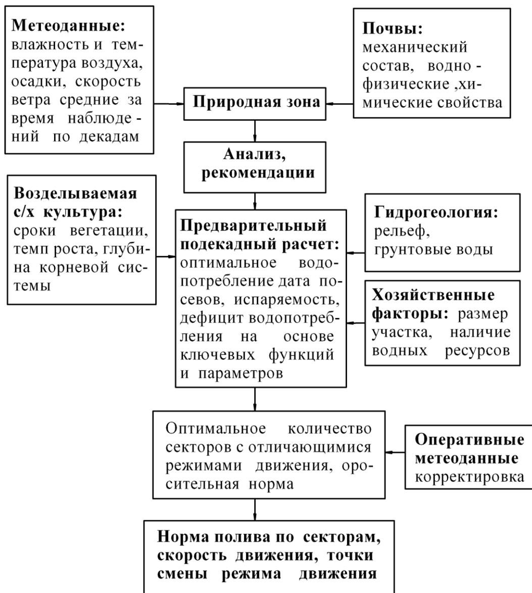
Рисунок 4.8 – Схема задания режима работы машины
