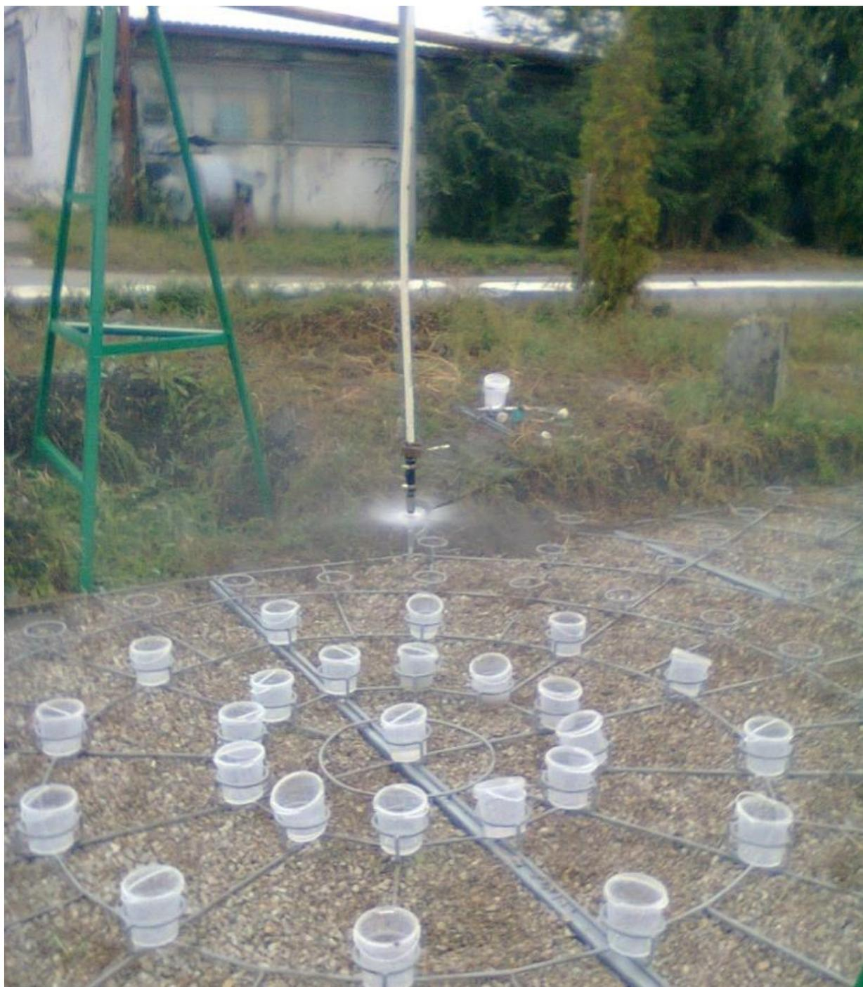
Рисунок 5.13 – Испытание дождевателей
