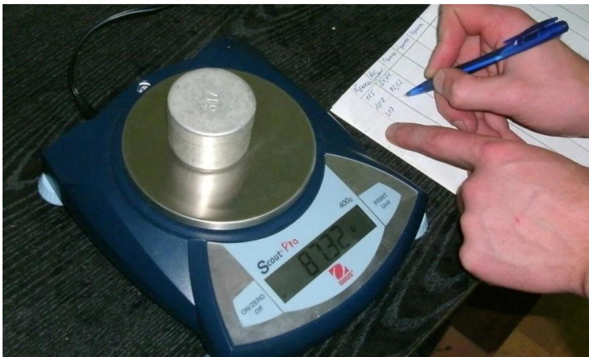
Рисунок 5.16 – Измерения влажности почвы
