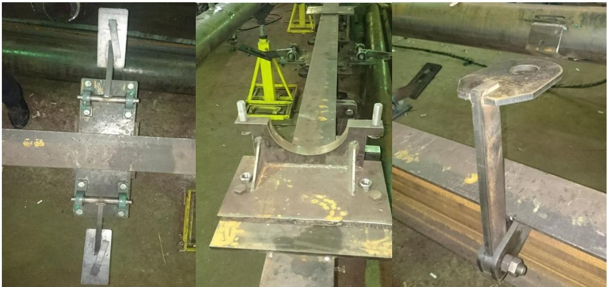
Рисунок 3.5 – Кондуктор изготовления водопроводящего трубопровода
