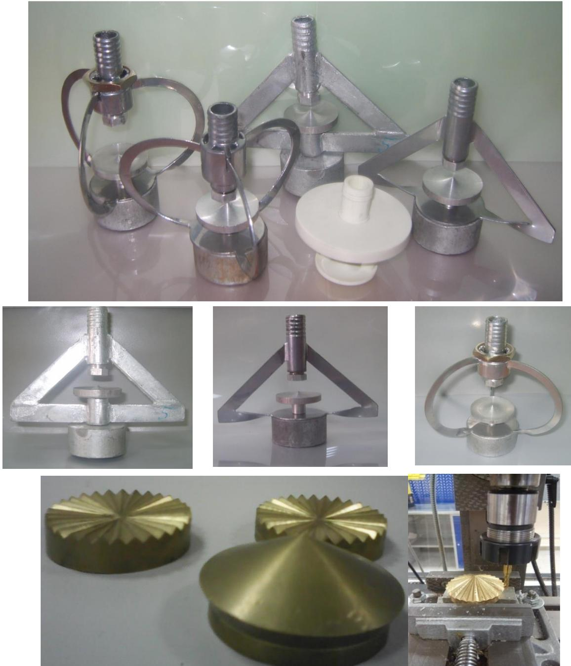
Рисунок 3.27 – Дождеватель из оцинкованной стали типа 1, сменные дефлекторы разной геометрии [29]
