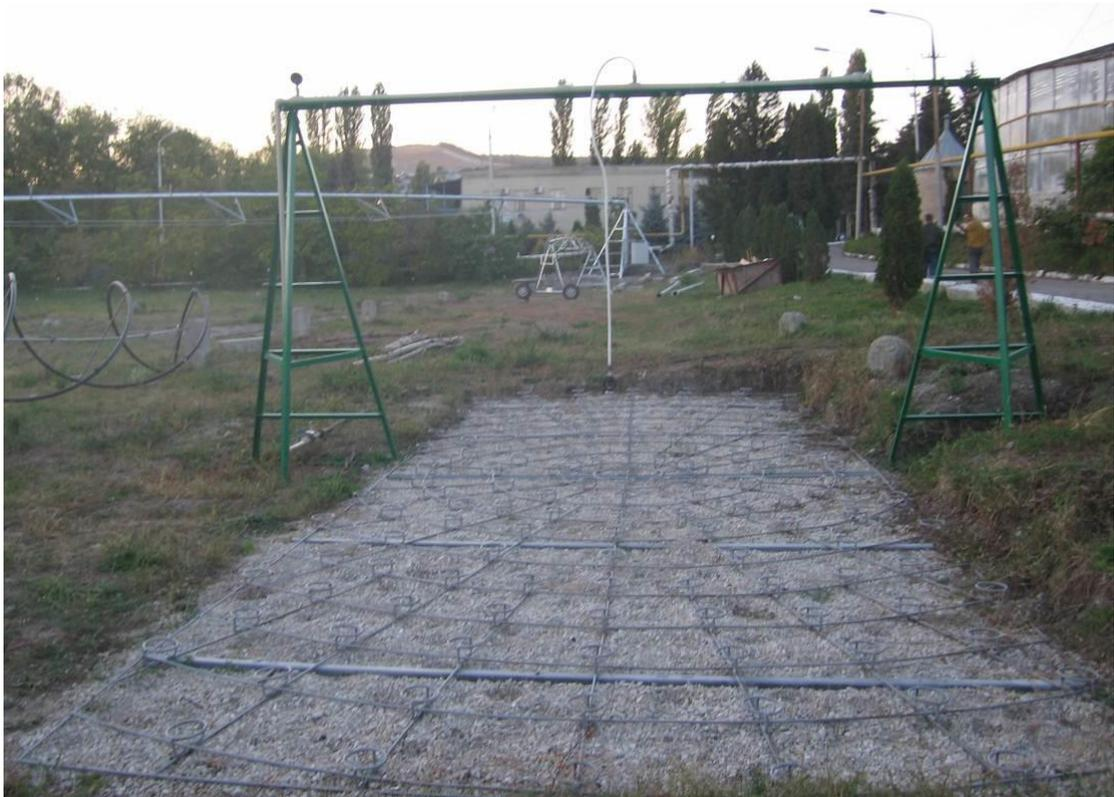
Рисунок 5.2 – Стенд для испытаний дождевателей
