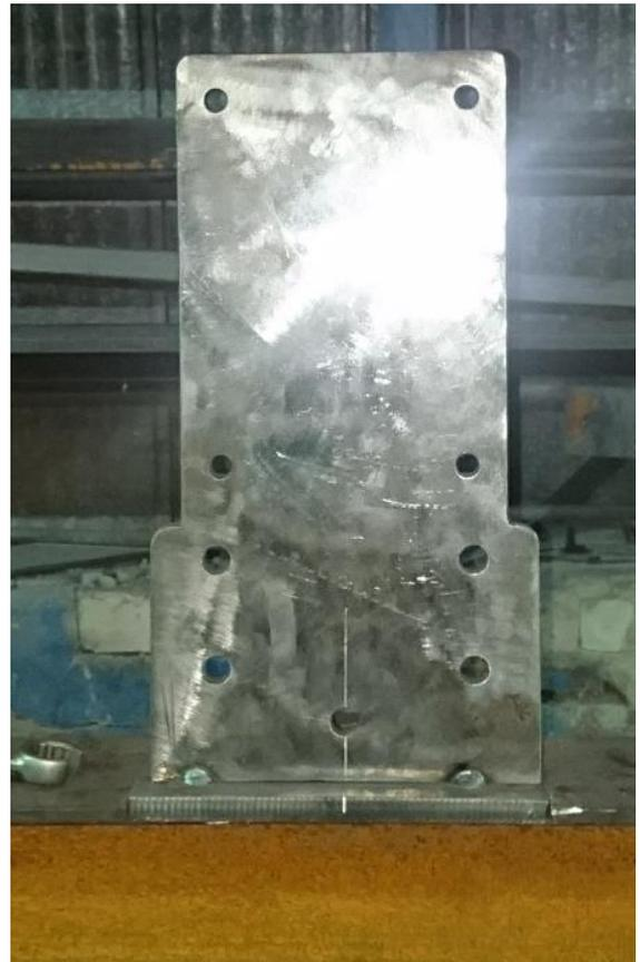
Рисунок 3.6 – Кондуктор изготовления опорных тележек
