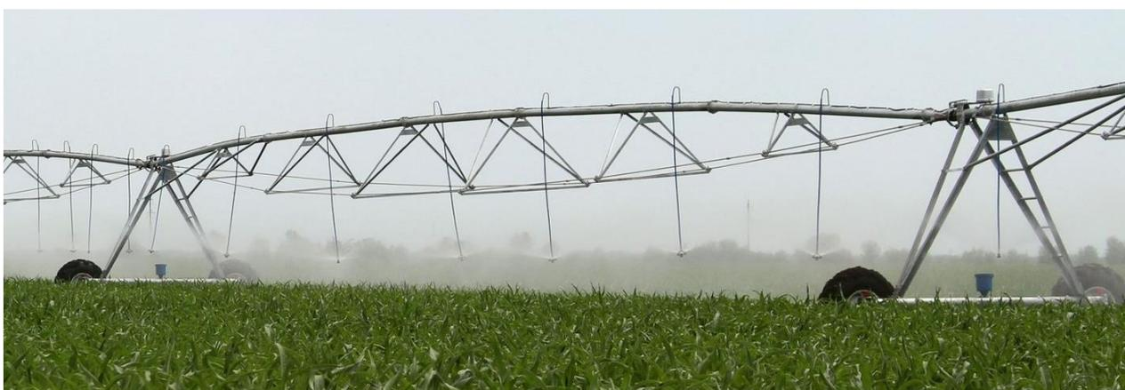
Рисунок 3.38 – Ферменная конструкция «Кубань-ЛК-1М» с длиной пролета 48,7м
