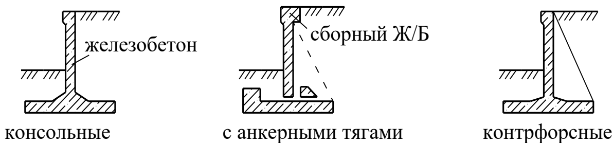
Рис. 6.2 - Тонкостенные подпорные стены углового профиля
