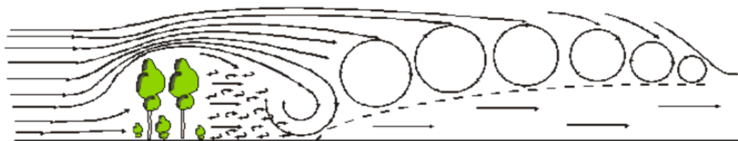
Рис. 1 Влияние полосы ажурной конструкции на движение ветра
