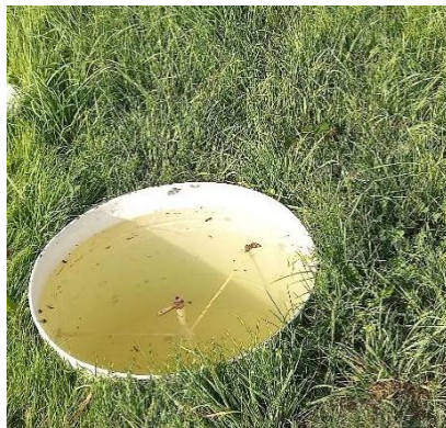
Рис. 1. Испаритель ГГИ-3000 на площадке Метеорологической обсерватории имени В.А. Михельсона
