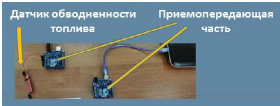
Рисунок 3 – Приемопередающие устройства системы контроля обводненности дизельного топлива
