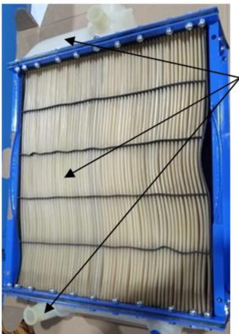
Рисунок 1 – Тракторный радиатор МТЗ-80 системы охлаждения двигателя с полиуретановой сердцевиной
