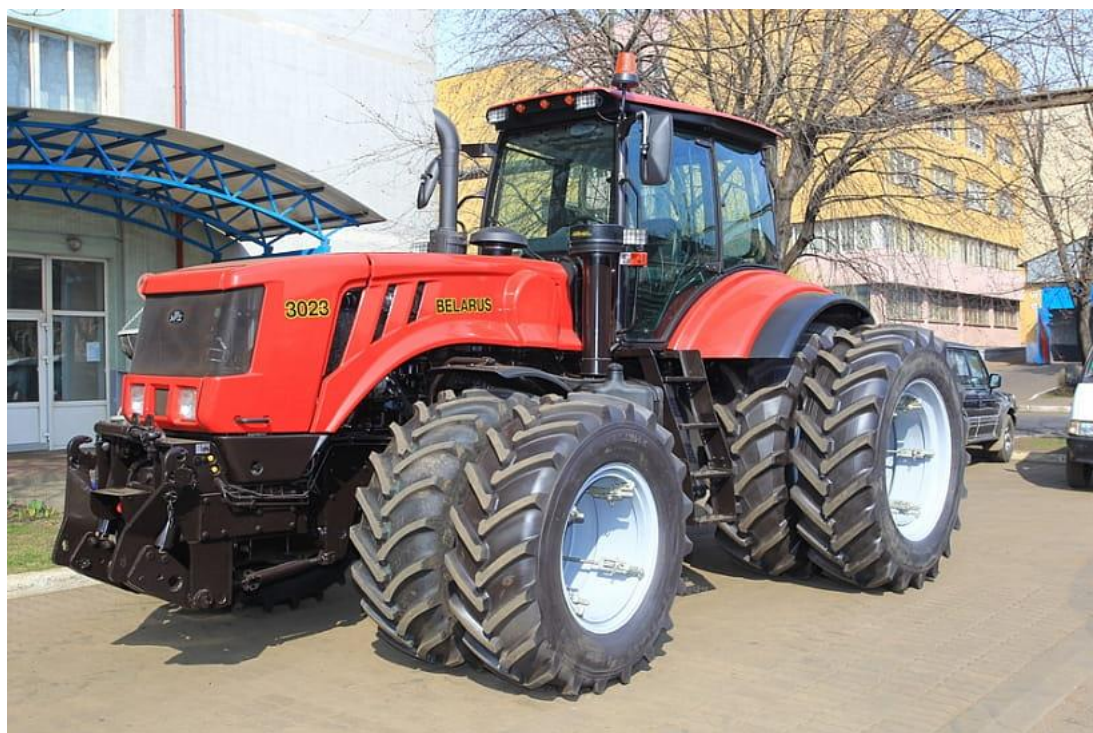
Рисунок 3 – Трактор МТЗ-3023 с электромеханической трансмиссией
