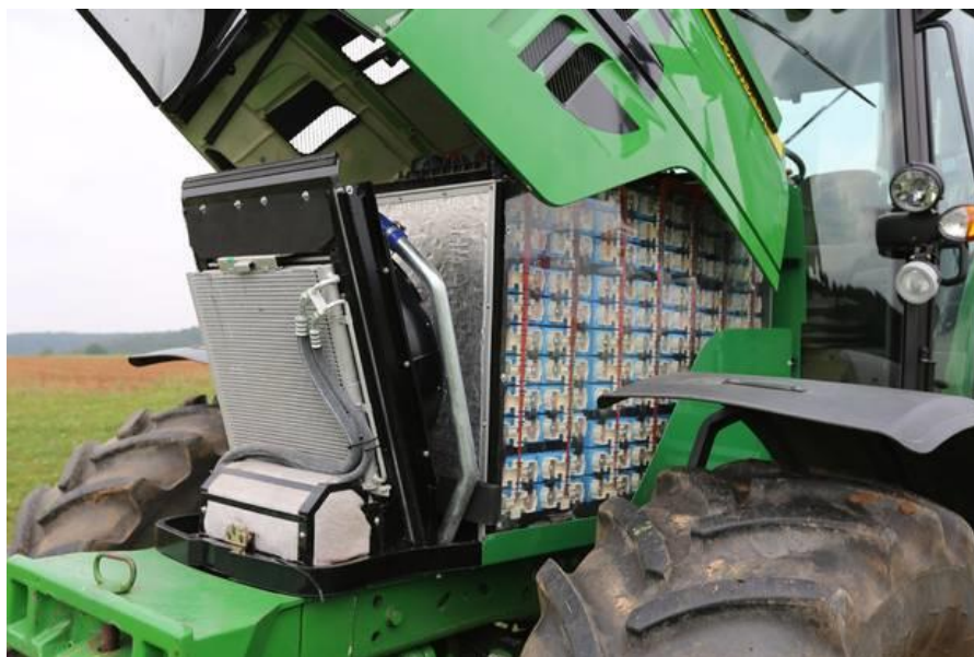
Рисунок 2 – Литий-ионные батареи электрического трактора John Deere Sesam
