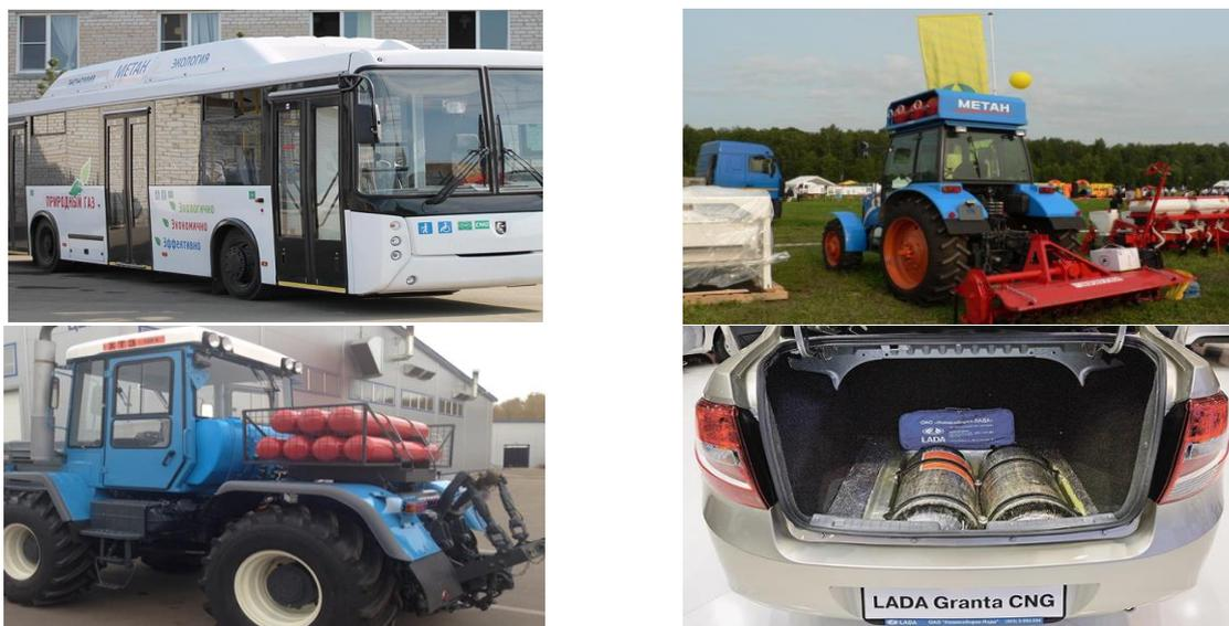
**Рисунок 1 – Примеры размещения запаса КПГ в автотракторной технике**
