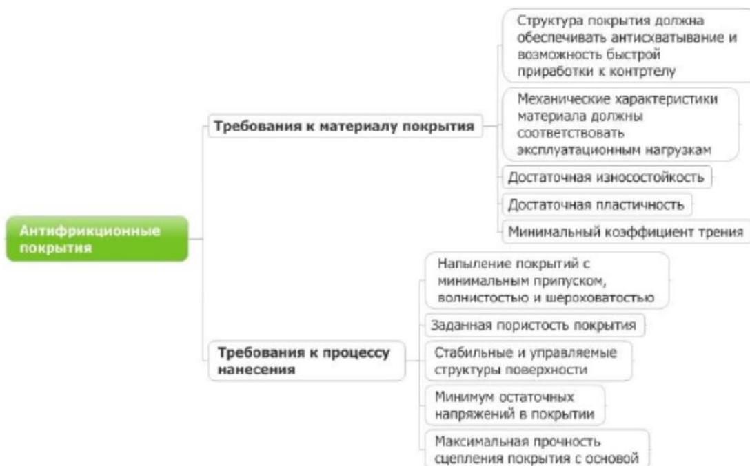
**Рисунок 3 – Требования, предъявляемые антифрикционными покрытиями**
