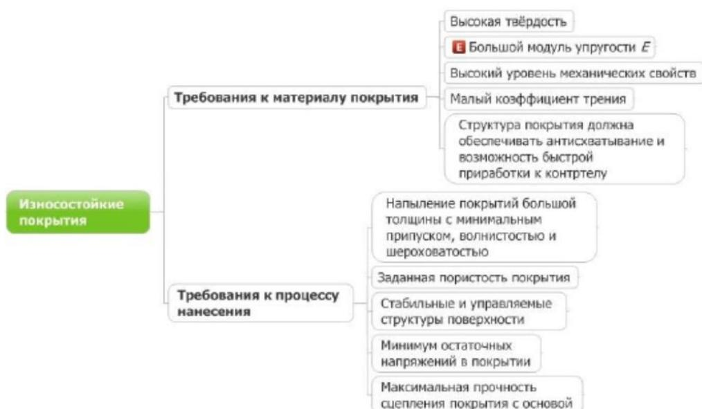
Рисунок 2 – Требования, предъявляемые износостойкими покрытиями
