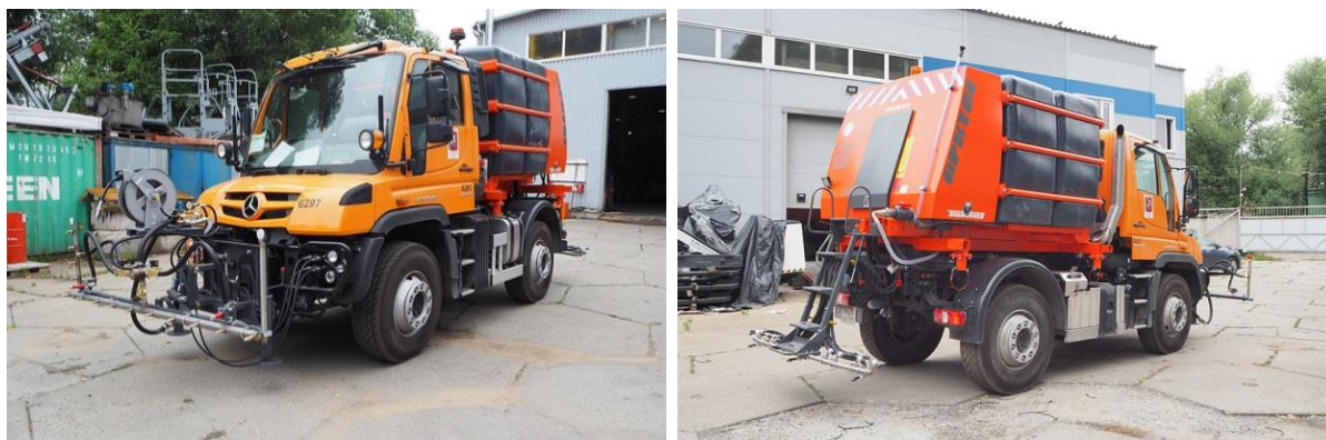
Рисунок 3 – КДМ на базе оборудования на шасси Mercedes-Benz Unimog
