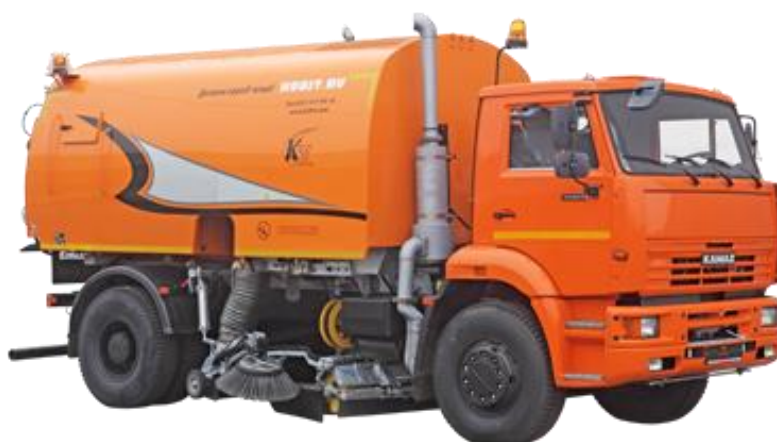
Рисунок 5 – Подметально-уборочная машина К 8 на шасси КАМАЗ
