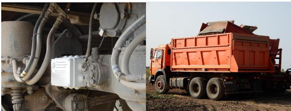
**Рисунок 2 – Установка модулей снятия данных движения транспортных средств**
