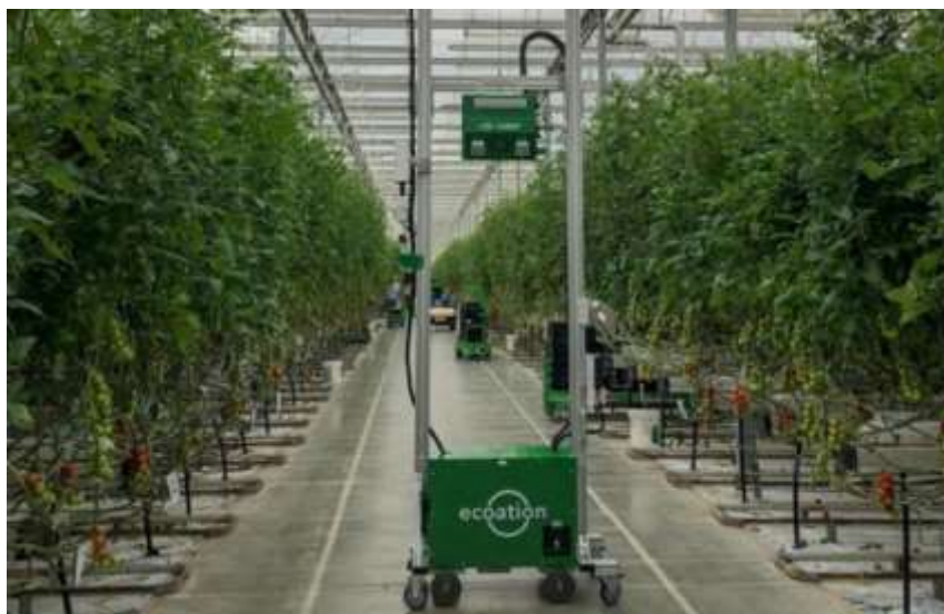
Рисунок – Робот для мониторинга состояния растений в теплице
