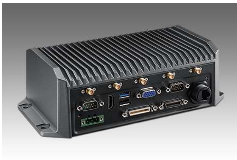
Рисунок 2 – Диагностирующий компьютер TREK-570 для строительно-дорожных машин
