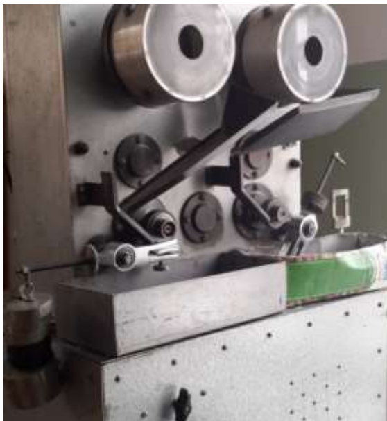
Рисунок 2 – Схема и общий вид испытательного стенда по ГОСТ 23.208-79 1 – образец; 2 – образцедержатель; 3 – рычаг; 4 – направляющий лоток; 5 – дозатор подачи абразивных частиц; 6 – резиновый ролик; 7 – привод; 8 – устройство контроля суммарного количества оборотов ролика
