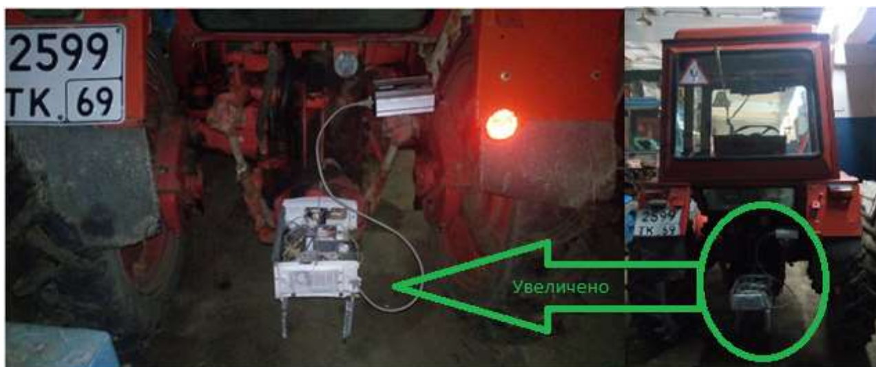
Рисунок 2 – Установленный прототип излучателя на трактор Т-25А
