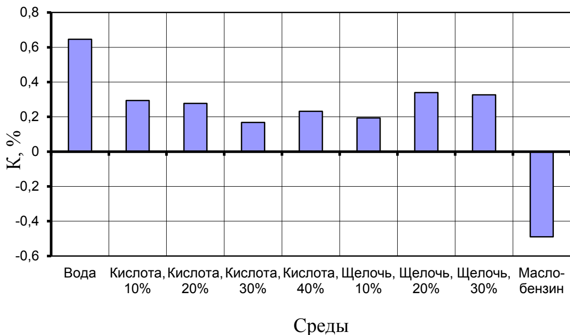
Рисунок 1 – Исследование изменения степени массопоглощения в агрессивных средах на 60-е сутки
