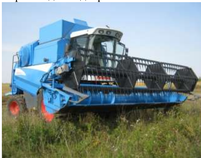
Рисунок 1 – Комбайн зерноуборочный самоходный с электрической трансмиссией рабочих органов
