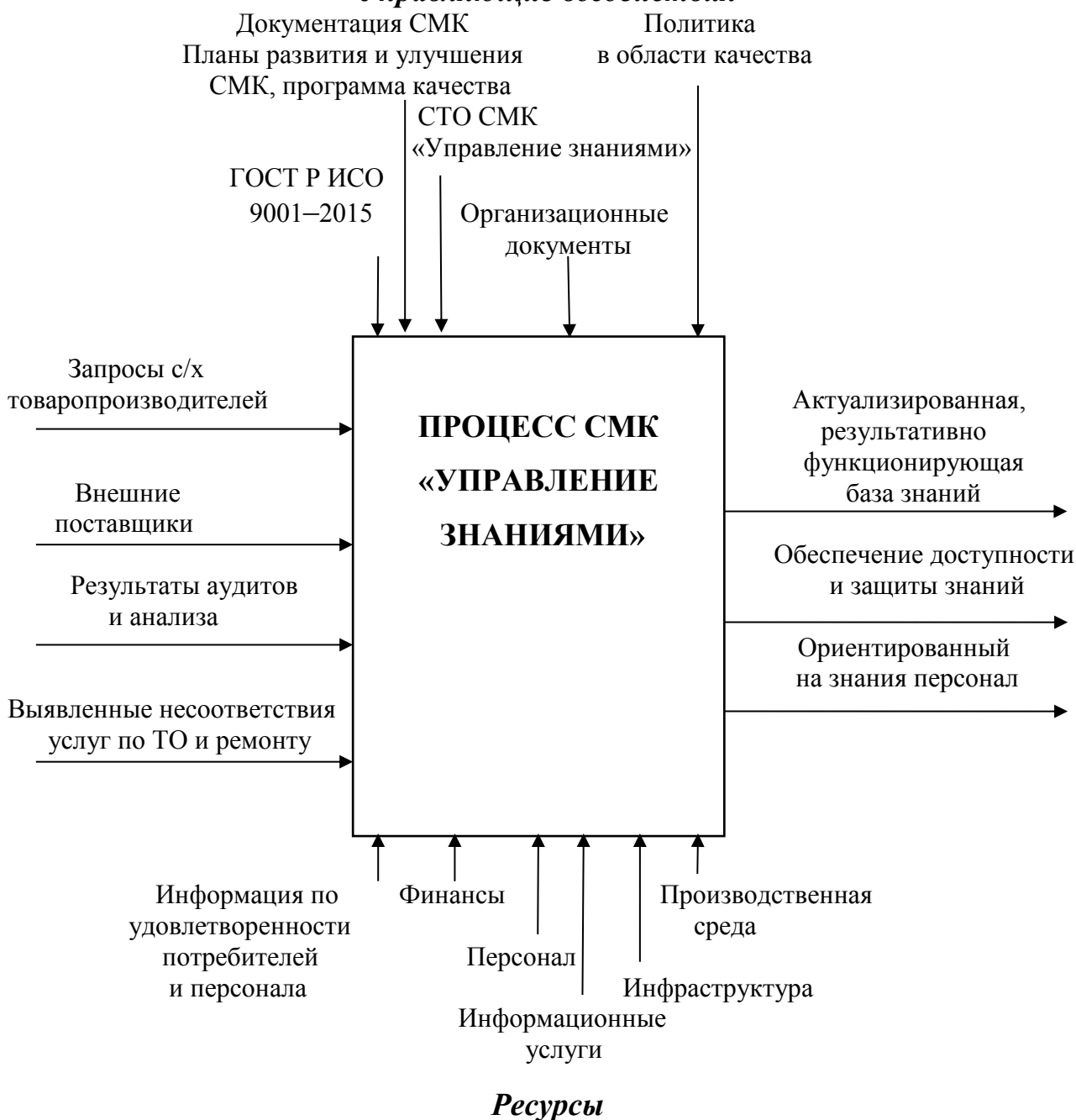
Рисунок 1 – Модель процесса «Управление знаниями» на предприятии технического сервиса АПК
