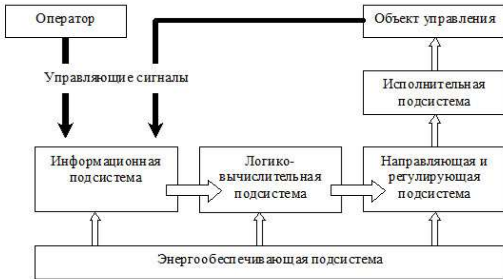
Рисунок 1 - Структурная схема системы автоматического управления пневматического привода
