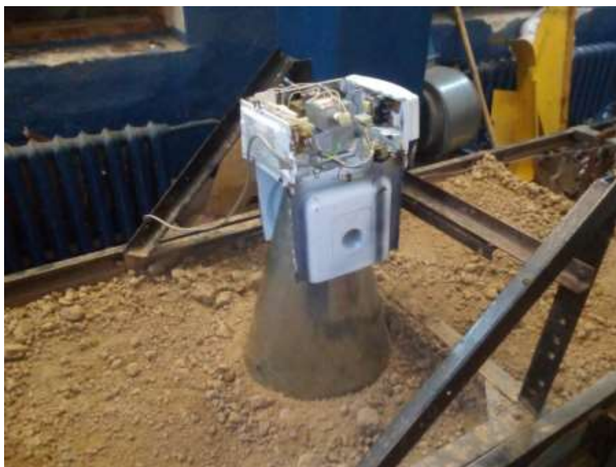
Рисунок 1 – Испытание прототипа излучателя на почвенном канале
