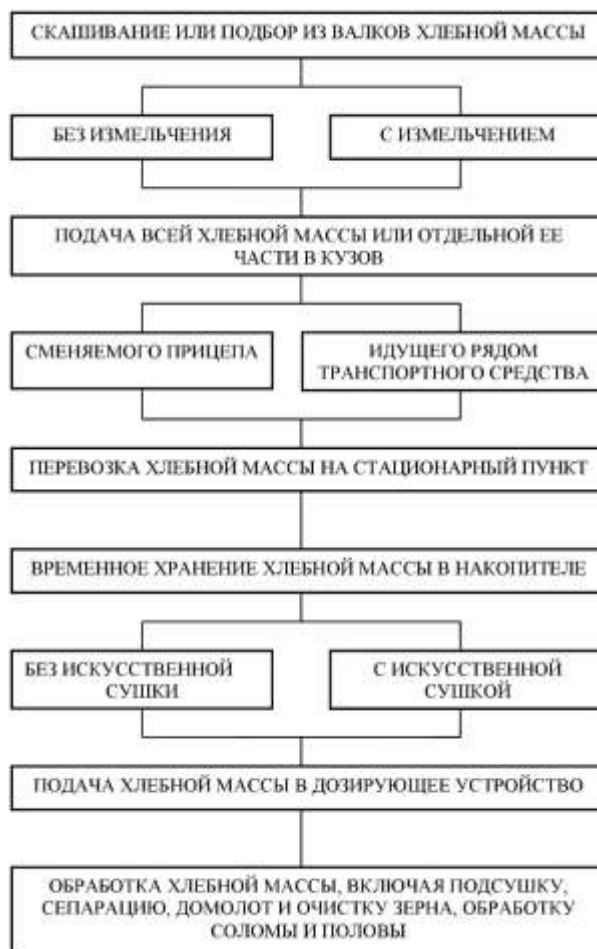
Рисунок 1 – Обобщенная технологическая схема многофазной уборки зерновых культур
