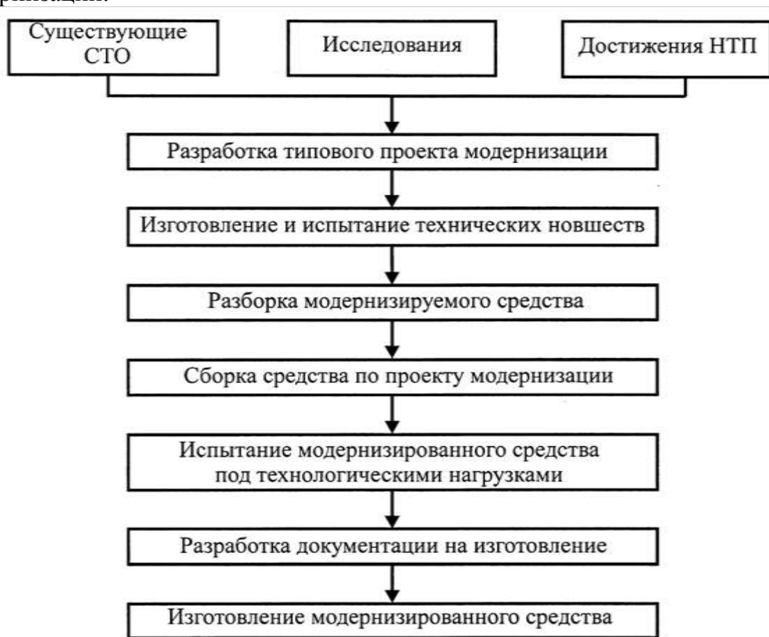
Рисунок 1 – Принципиальная блок-схема модернизации средств технологического оснащения
