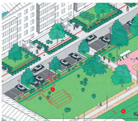
Рисунок 3 – Подземный резервуар очистки стоков с модульными кессонами для удержания и инфильтрации стоков, проницаемыми покрытиями и искусственным локальным понижением рельефа
