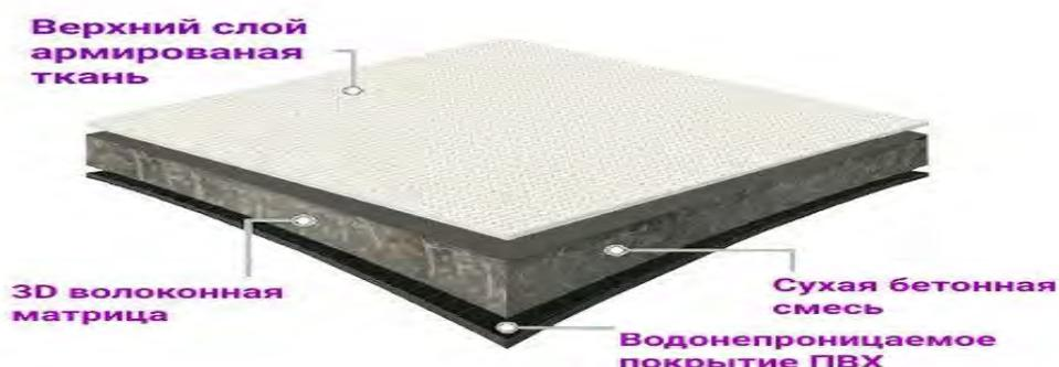
Рисунок 3 – Структура бетонного полотна
