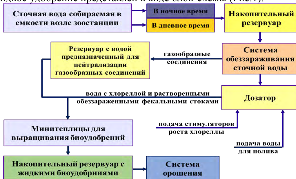
Рисунок 1 – Процесс биологической переработки жидких органических удобрений в виде фекальных стоков и измельченного навоза в ценное жидкое удобрение
