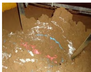
Рисунок 2 - Деформация слоев грунта: а – в поперечной плоскости; б – в продольной плоскости
