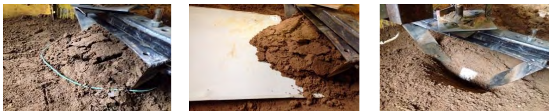
Рисунок 1 – Схемы измерения объёма и массы разрыхлённого грунта
